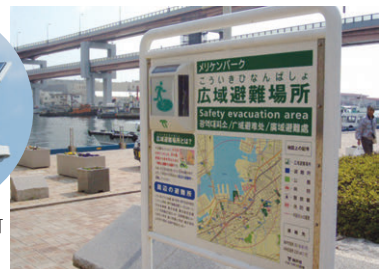
太陽光発電式避難場所発光サイン「ソーラーピクト」 (リンテック(株)、豊田合成(株)共同開発)
